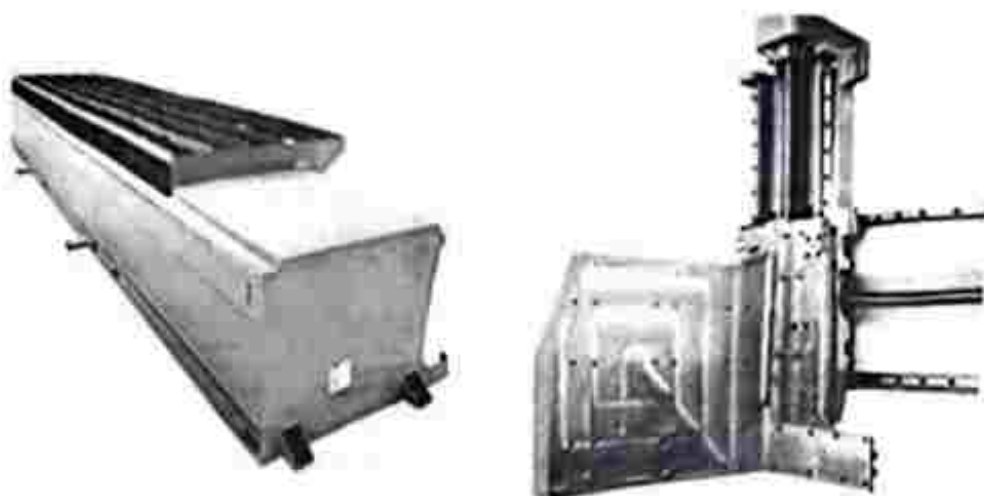
شکل (۴-۵۰): قسمت های خاصی از شاسی میز و بدنه که معمولاً جهت تکرار پذیری دقت های ماشین به وسیله عملیات حرارتی و یا التراسونیک تنش زدایی می شوند.
