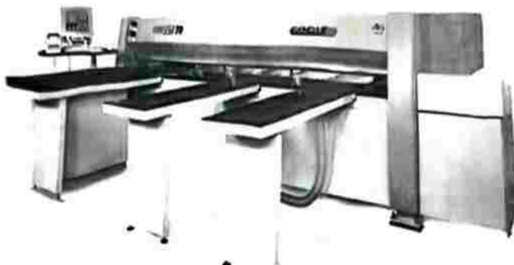
شکل (۴-۷۵): ماشین پانل بر افقی تمام اتوماتیک با قابلیت برش چندین پانل و صفحات فشرده چوبی به صورت همزمان
